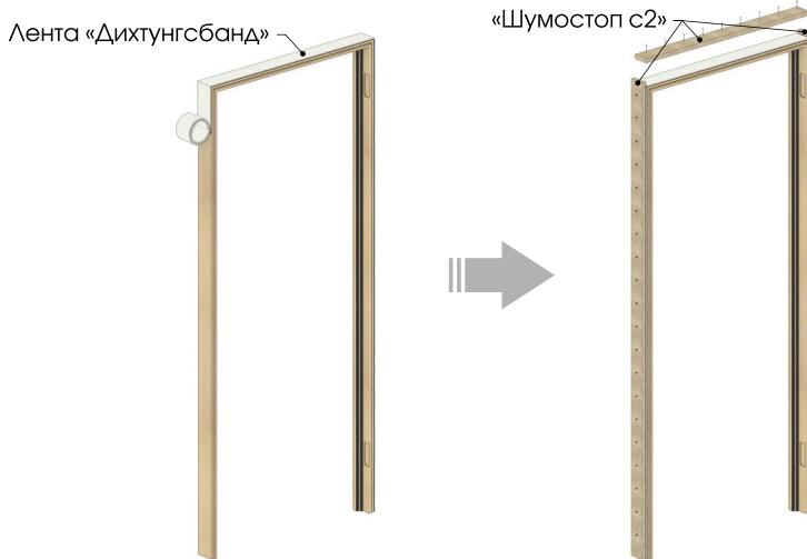
По внешнему периметру дверной коробки со стороны монтажного шва закрепить на скобы уплотнительную ленту «Дихтунгсбанд» 95х3 мм. Без разрывов в угловом соединении коробки.
