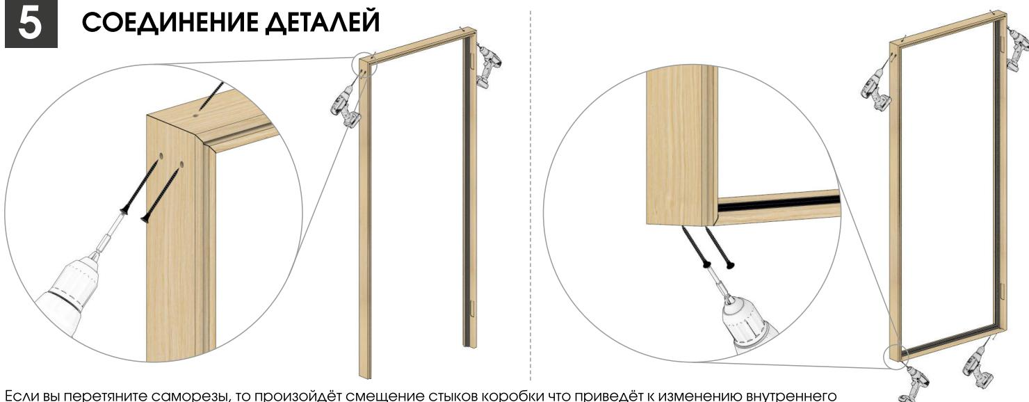
Если вы перетянете саморезы, то произойдёт смещение стыков коробки что приведёт к изменению внутреннего размера собранной коробки под размеченные размеры полотна. В этом случае ослабьте перетянутые саморезы и повторите их закручивание.
