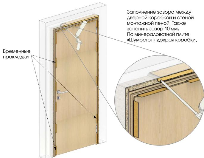
Перед запениванием рекомендуется обеспылить проём и смочить его водой из пульверизатора для лучшей адгезии. В зазоры между коробкой и полотном рекомендуется установить временные прокладки из картона или других материалов для дополнительного усилия на дверную коробку во время высыхания пены.
