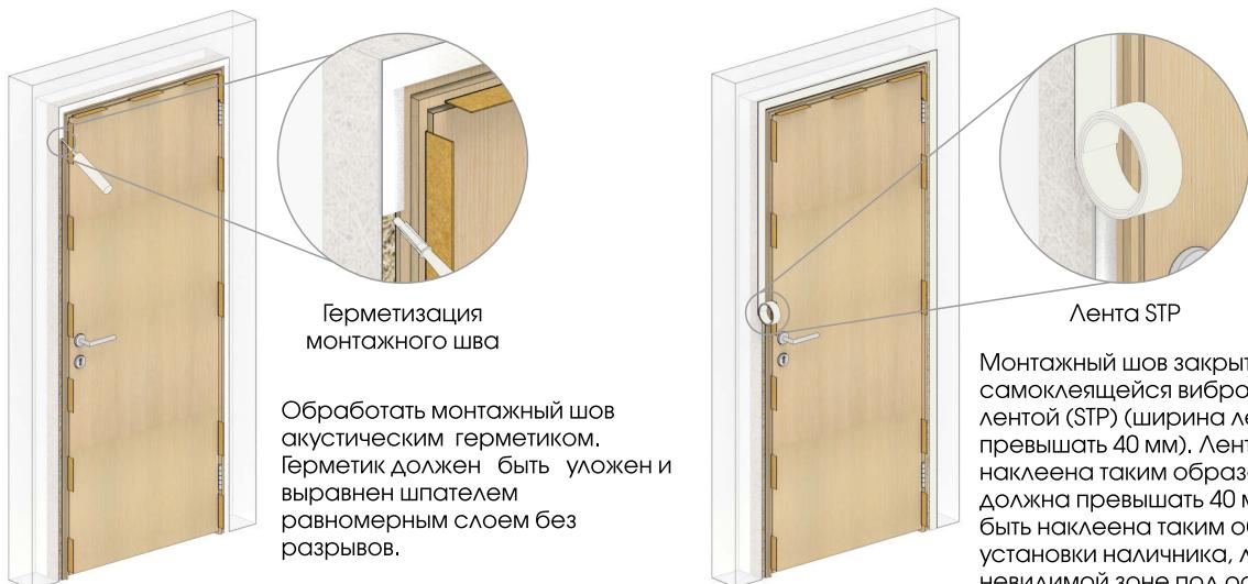
Обработать монтажный шов акустическим герметиком. Герметик должен быть уложен и выровнен шпателем равномерным слоем без разрывов.
