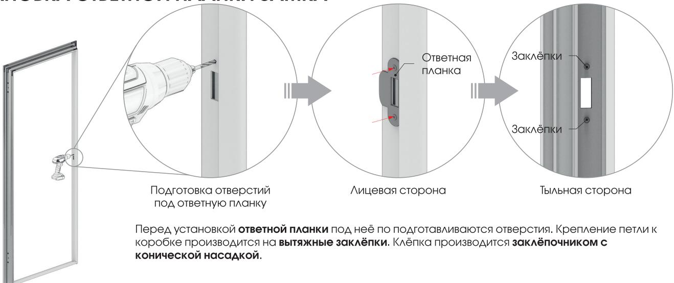
Перед установкой **ответной планки** под неё по подготавливаются отверстия. Крепление петли к коробке производится на **вытяжные заклёпки**. Клётка производится **заклётчиком с конической насадкой**.
