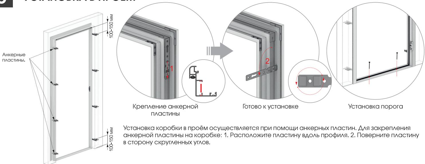
Установка коробки в проём осуществляется при помощи анкерных пластин. Для закрепления анкерной пластины на коробке: 1. Расположите пластину вдоль профиля. 2. Поверните пластину в сторону скругленных углов.
