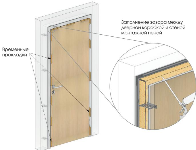
Перед запениванием рекомендуется обеспылить проём и смочить его водой из пульвилизатора для лучшей адгезии. В зазоры между коробкой и полотном рекомендуется установить временные прокладки из картона или других материалов для дополнительного усилия на дверную коробку во время высыхания пены.
