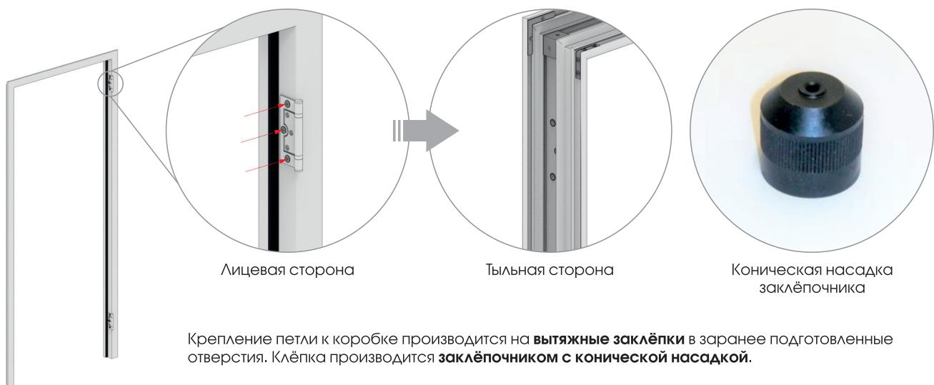
Крепление петли к коробке производится на **вытяжные заклёпки** в заранее подготовленные отверстия. Клётка производится **заклёпочником с конической насадкой**.
